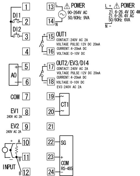
「注」：熱電対・電圧入力で端子11と端子12を短絡すると誤差を生じます。
