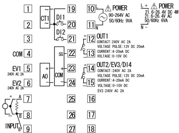
「注」：熱電対・電圧入力で端子8と端子9を短絡すると誤差を生じます。
