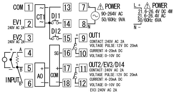
「注」：熱電対・電圧入力で端子5と端子6を短絡すると誤差を生じます。
