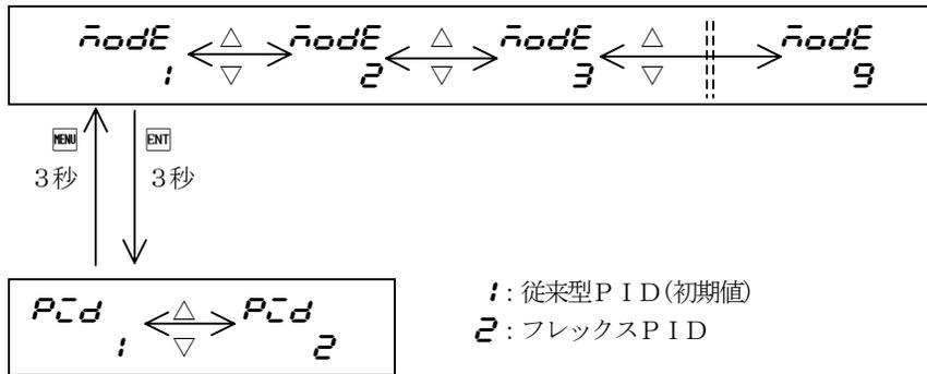
モード1からモード9までの先頭画面表示でENTキーを3秒押し、PID方式選択画面が表示され、▲▼キーで1：従来型PID か 2：フレックスPIDを選択し、ENTキーで確定します。
