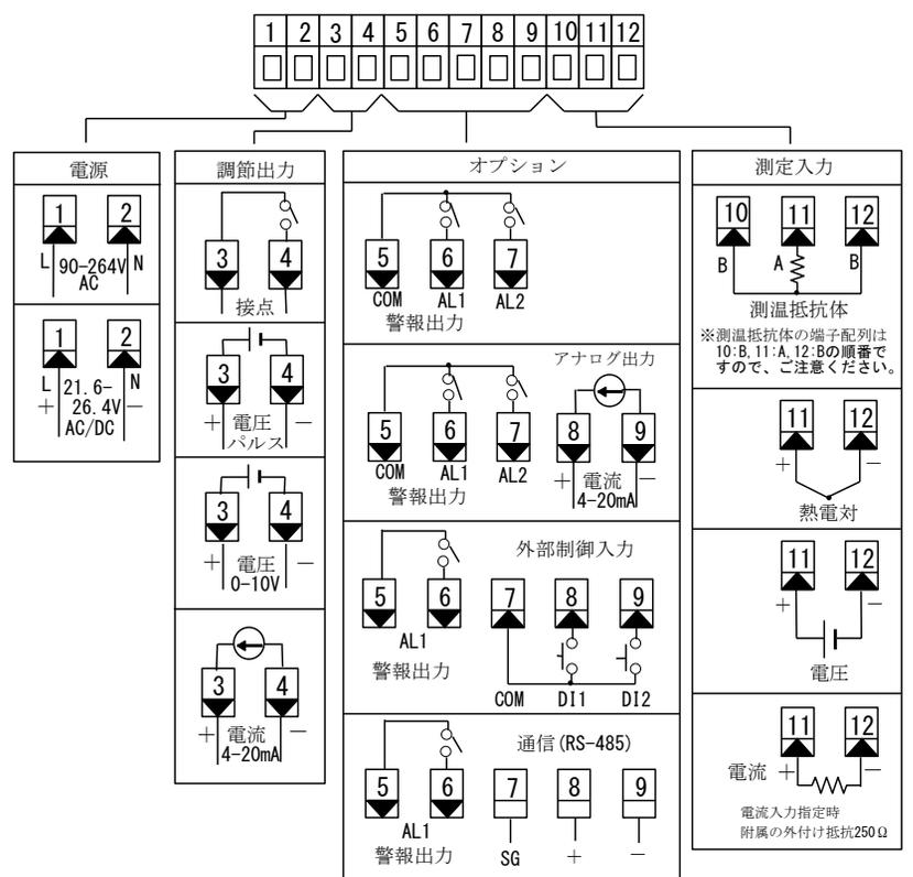
「注」：熱電対・電圧入力で端子10と端子12を短絡すると誤差を生じます。
