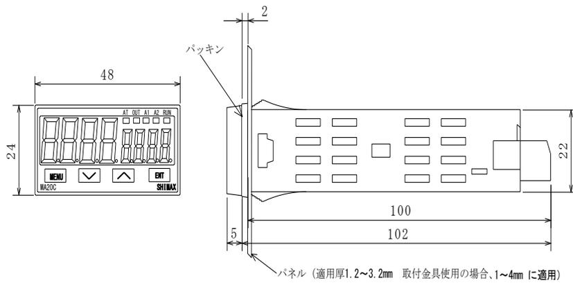
MA20Cパネルカット図 (単位：mm)
